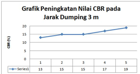
**Gambar 6.** Peningkatan nilai CBR pada jarak *dumping* 3 m
