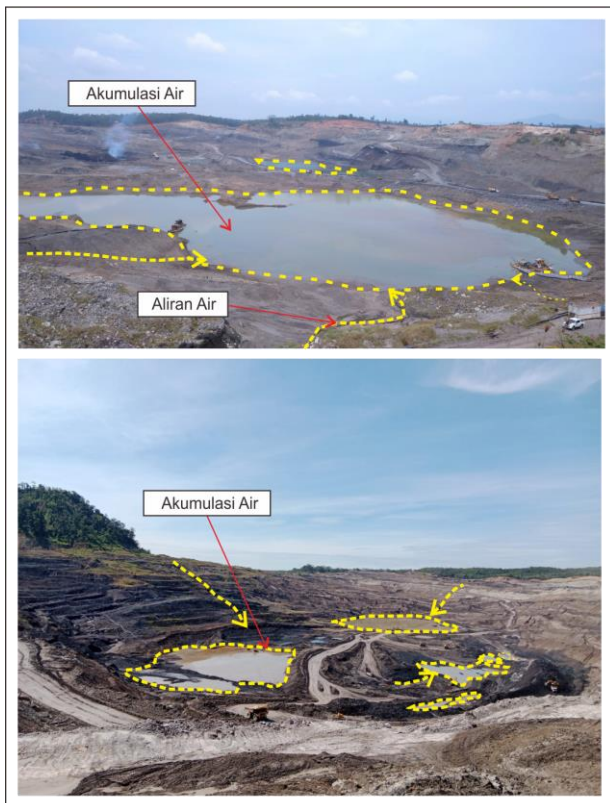
Gambar 5. Kondisi aliran dan akumulasi air aktual yang ditemukan pada lokasi penelitian
