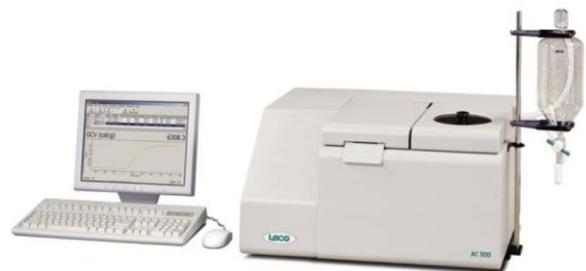
Gambar 2. Alat *Automatic Calorimeter* untuk pengukuran nilai kalori
