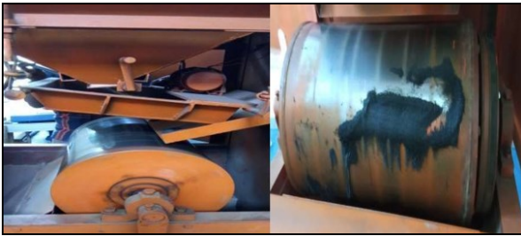
Gambar 2. Proses pemisahan magnetik (kiri), material magnetik yang melekat pada drum magnet (kanan)
