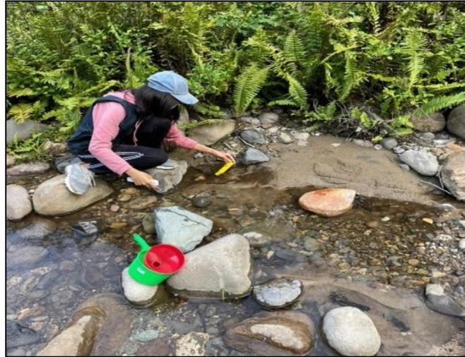
**Gambar 4.** Pengambilan data TDS, DHL, pH dan temperatur air permukaan serta pengambilan sampel fluida pada manifestasi mata air panas di Sungai Mantenang untuk analisis geokimia
