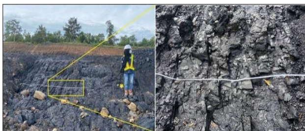
Gambar 4. Metode pengukuran scanline .
