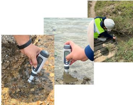
Gambar 9. Kegiatan Uji Air Asam Tambang pada Outlet Void PT BBK
