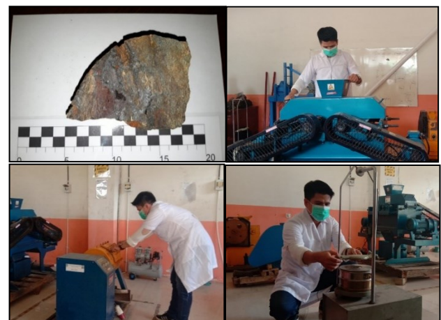
Gambar 2. Proses mempersiapkan conto untuk keperluan pengujian dan pemisahan magnetic
