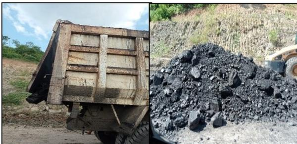
**Gambar 7.** *Tail-gate dump truck* yang tidak terkunci
