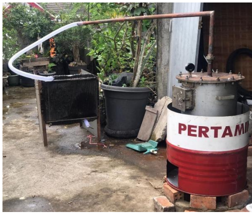
Gambar 10. Final Rancang Bangun Alat Produksi Asap Cair dengan Teknologi Pirolisis
