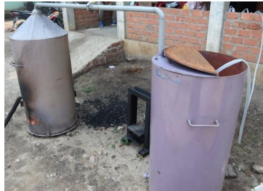
Gambar 11. Alat Produksi Asap Cair sebelum Modifikasi
