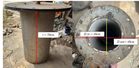
Gambar 5. Desain perancangan reaktor
