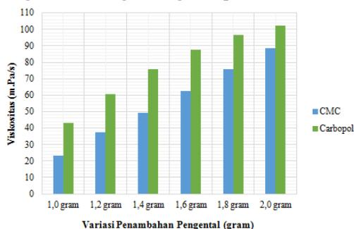
**Gambar 2.** Viskositas Bioetanol Gel dengan Variasi Bahan Pengental
