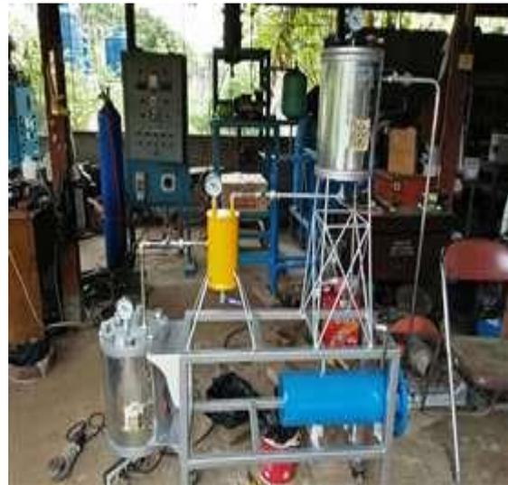
**Gambar 3.** Instalasi peralatan produksi SNG dengan proses gasifikasi katalitik
