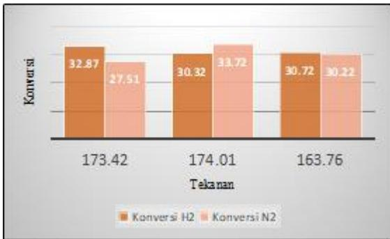
**Gambar 3.** Tekanan pada *Ammonia Converter* terhadap koversi N<sub>2</sub> dan H<sub>2</sub> Secara Aktual
