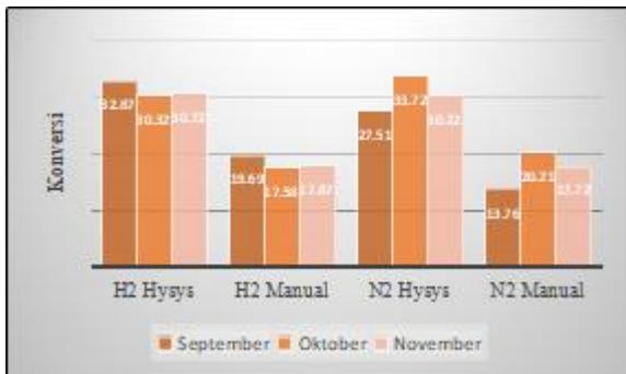
**Gambar 8.** Perbandingan Perhitungan Konversi H<sub>2</sub> dan N<sub>2</sub> dengan Menggunakan Hysys 8.8 dan Manual
