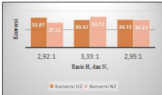
**Gambar 7.** Perbandingan Konversi H<sub>2</sub> dan N<sub>2</sub> pada *Ammonia Converter* dari Data Desain dan Aktual
