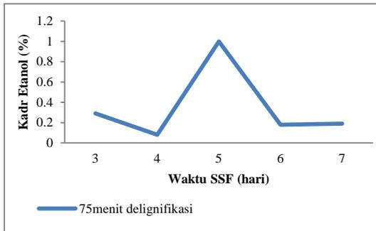
**Gambar 6.** Kadar Etanol Hasil Analisa GC Setelah Proses SSF
