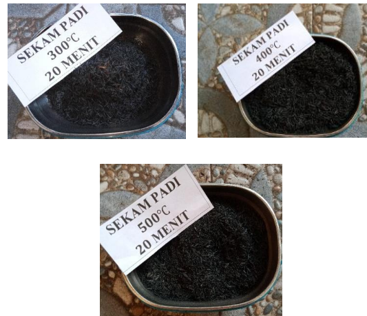
Gambar 2. Hasil karbonisasi sekam padi selama 20 menit dengan berbagai variasi temperatur.
