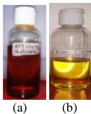
Gambar 6. (a) Minyak jelantah sebelum adsorpsi, (b) Minyak hasil adsorpsi pada rasio 100:0 di waktu 120 menit
