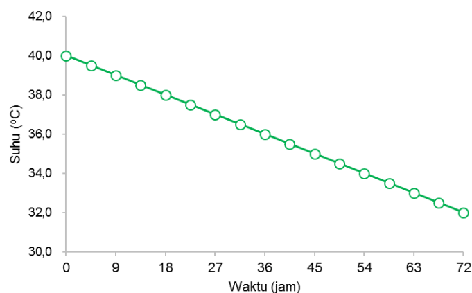
Gambar 1. Profil penurunan suhu linier dalam proses kristalisasi batch
