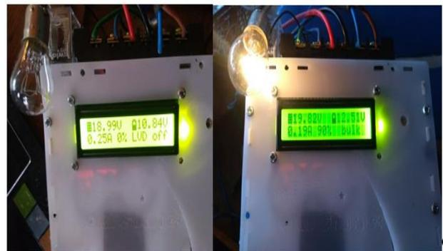
Gambar 9 Saat keadaan baterai *low voltage disconnected* Pengujian Tahap Pengecasan Baterai
