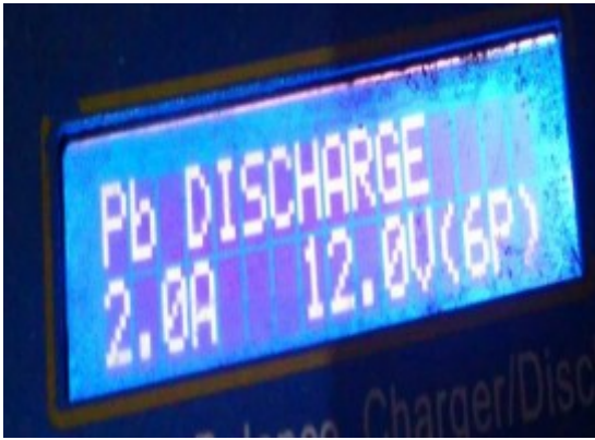
Gambar 9. Discharge Menggunakan Charger Lippo
