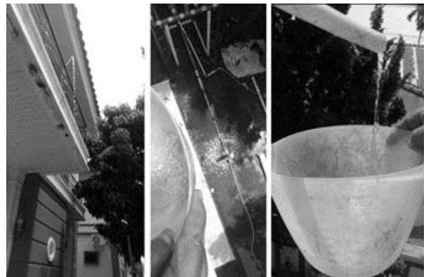
Gambar 8 Pengukuran debit output pompa hidram
