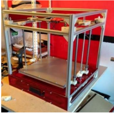
Gambar 4. Rancang bangun mesin cetak 3D tipe FDM ( Fused Deposited Modelling ) dengan proses cetak objek 3D secara offline printing yang digunakan dalam kegiatan pelatihan.
