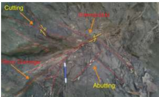
Gambar 9. Analisis urat kuarsa menunjukkan geometri cutting dan abutting LP 6 dengan arah azimuth N 94° E di Sungai Srikaton Desa Srikaton
