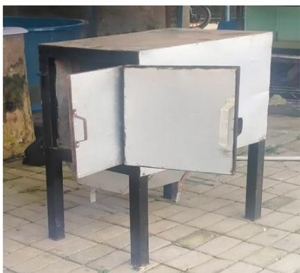
Gambar 9 Alat pengering berkapasitas 5 kg
