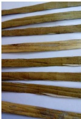
Gambar 5. Purun yang dipipihkan dengan cara ditumbuk
