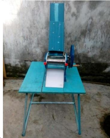
Gambar 5a. Tampak depan Mesin Pemipih Purun
