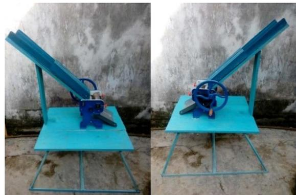
Gambar 5. Tampak samping kiri dan samping kanan Mesin Pemipih Purun [11] [12]
