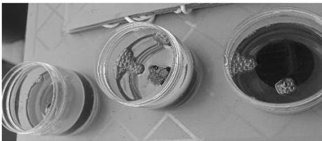
Gambar 2a. Briket sekam padi tanpa perendaman minyak goreng , 1b. Briket sekam padi dengan perendaman minyak goreng Uji Nyala
