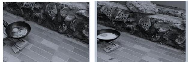
Gambar 4 Uji pemasakan bahan pangan telur menggunakan bahan bakar briket sekam padi tanpa dan dengan perendaman minyak goreng.
