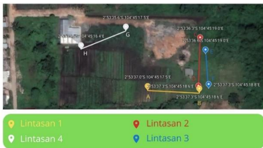
Gambar 5 Lokasi lintasan-lintasan pengukuran Geolistrik 2 D (Dokumentasi penelitian)
