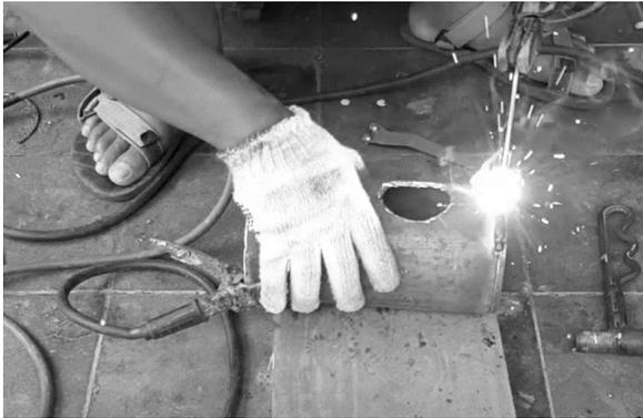
Gambar 4. Pengelasan bagian-bagian kompor oli bekas
