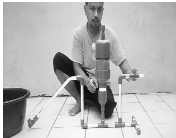
Gambar 9 Pompa Tanpa motor dari pipa dengan tabung vakum lebih besar (video)
