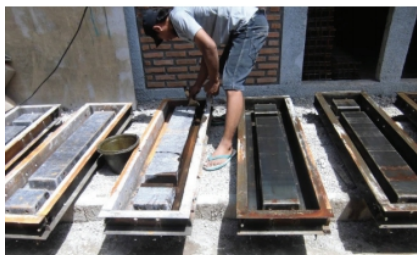
Gambar 4 Pengolesan minyak di cetakan (sumber: Rudi, 2019)
