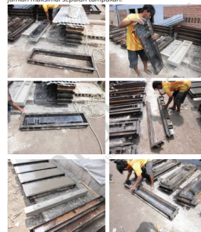
Gambar 5 Proses penyimpanan dan pelepasan Ruspun dari cetakan (sumber: Rudi, 2019)
