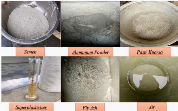
Gambar 1 Bahan-bahan yang digunakan pada campuran
