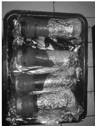
Gambar 4. Metode Isolasi Termal dan Tekanan dalam Reaktor
