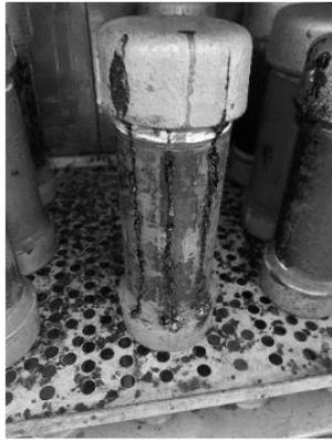
Gambar 3 Visualisasi Kebocoran Reaktor
