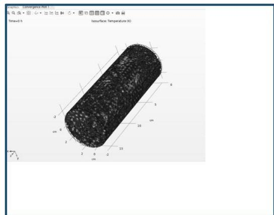
Gambar 18. Visualisasi kondisi reaktor 3D saat  $t_0 = 0$  jam (Sumber : visual COMSOL 5.5)
