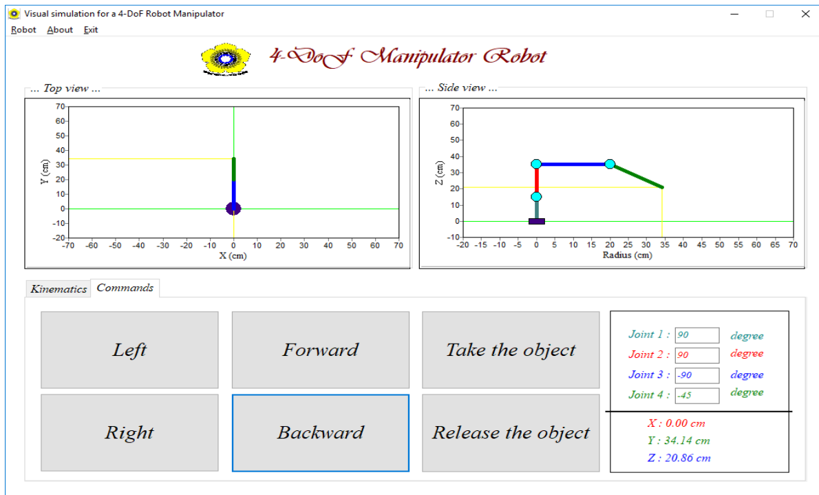
Gambar 5. Simulasi komputer untuk robot manipulator 4-DoF.
