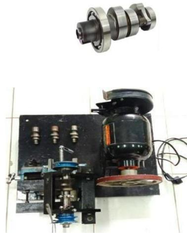
Gambar 2 Geometri *camshaft* dan mesin gerinda *camshaft* yang diterapkan di bengkel motor Tamsis
