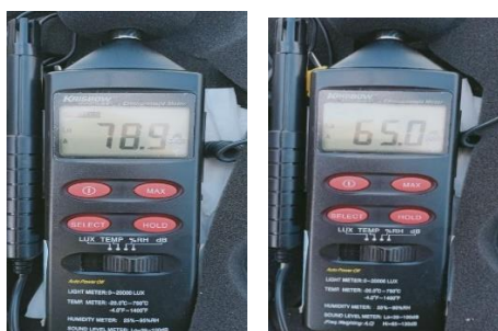
Gambar 4 Perbandingan hasil pengukuran air blast (SMBR, 2023)
