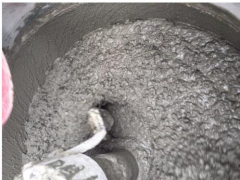
Gambar 1. Adukan beton SCC
