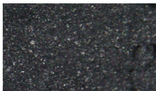
Gambar 7. Hasil Penggilingan Serbuk Al/Grafit/Fly Ash Perbandingan Ball Mill : Serbuk7: 1
