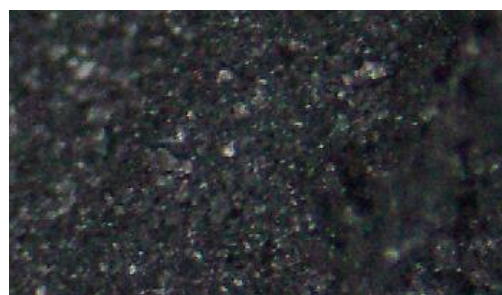
Gambar 8. Hasil Penggilingan Serbuk Al/Grafit/Fly Ash Perbandingan Ball Mill : Serbuk 9: 1
