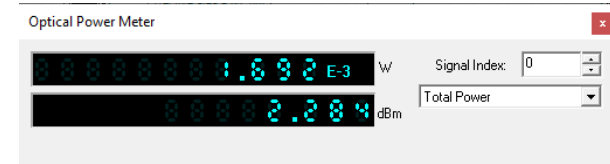
Gambar 10. Hasil Signal Power Fiber Optik 2 dari Simulasi Perancangan Jaringan FTTH Talang Duku-Grissik Pada OptiSystem
