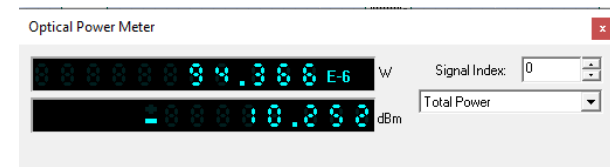
Gambar 11. Hasil Signal Power Receiver dari Simulasi Perancangan Jaringan FTTH Talang Duku-Grissik Pada OptiSystem
