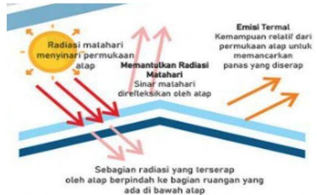
Gambar 3. Cara kerja cat saat pemantulan dalam spektrum inframerah
