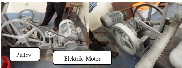
Gambar 3 Sistem penggerak shaking table elektrik motor sistem pulley .
