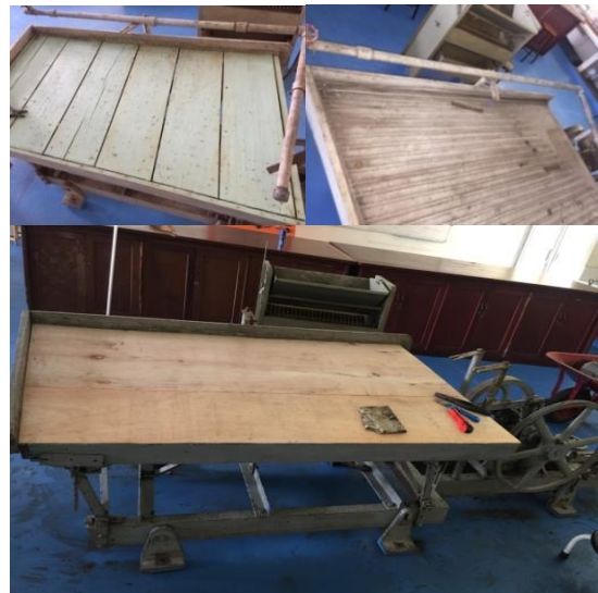
Gambar 1 Hasil perancangan meja/deck shaking table .
