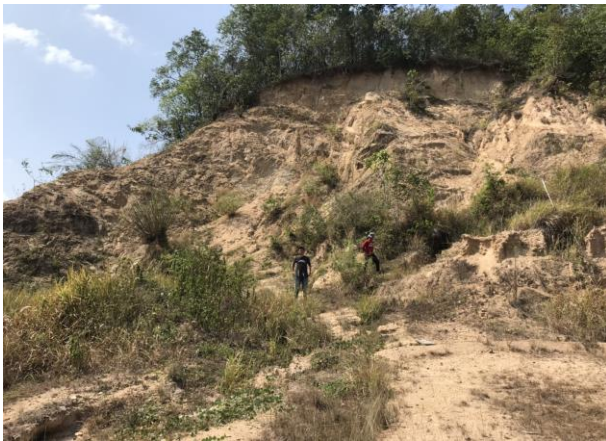
Gambar 4a Singkapan granit (granit garba) yang telah mengalami pelapukan berat dan pernah terjadi longsor sekitar 1 tahun yang lalu
