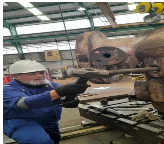
Gambar 16. Simulasi Pemasangan Pin Dowel
