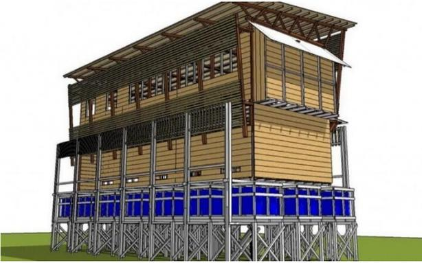
Gambar 4 Ark'a Modulam modul A dalam Proposal Desain Taman Kanak-Kanak dan Panti Asuhan di Komplek Mendawau Palangka Raya.
