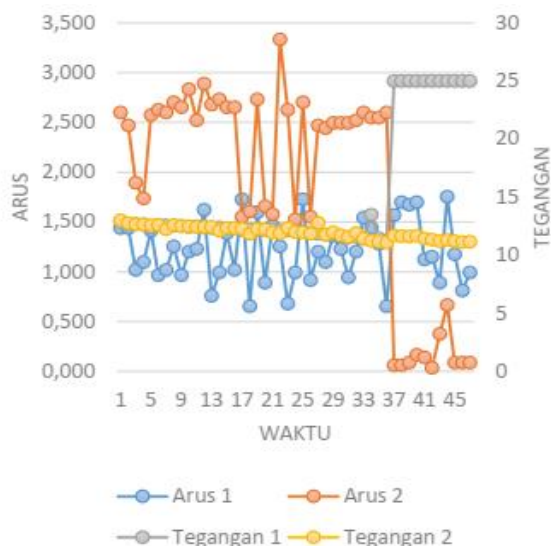
Gambar 3 Grafik Arus dan Tegangan dengan Beban 25 Watt.
