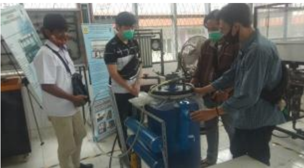
Gambar 5 Biodigester biogas yang siap dimasukkan sampel sampah.
