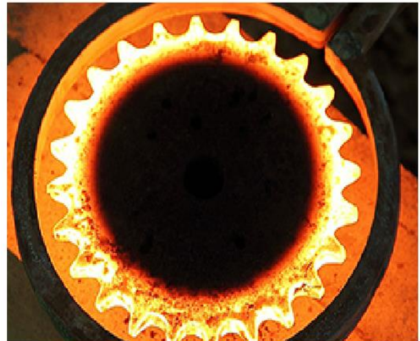
Gambar 3 Contoh roda gigi yang sudah dipanaskan (Henan Foco Machinery Co., Ltd)
