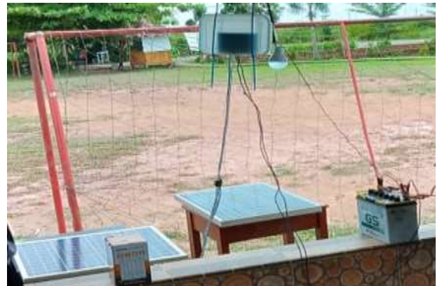
Gambar 5 Sistem pembangkit tenaga matahari 2 x 50 Wp.
