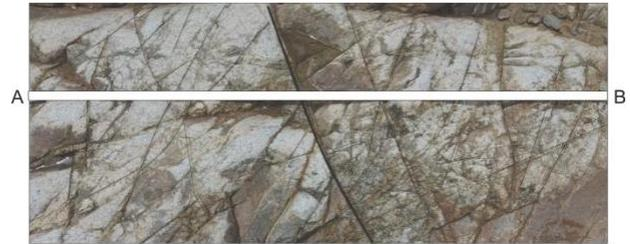
Gambar 2 Pengukuran *attribut fracture* menggunakan metode *scanline sampling*
