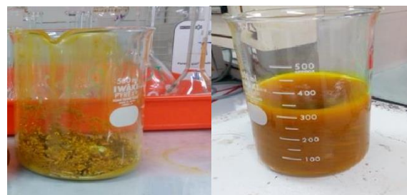
Gambar 1 Persiapan sampel kunyit dan solven dengan rasio 1:2
