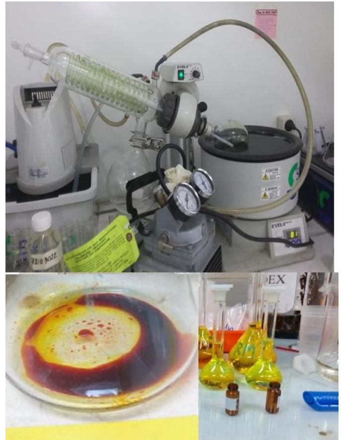
Gambar 3. Hasil pemisahan Solven dan produk kurkumin dengan alat Rotari Evaporator
