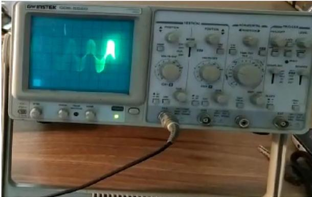
Gambar 11 Bentuk gelombang inverter sinusoidal 1300 VA tanpa menggunakan kapasitor.
